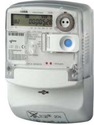
الشكل ١٤ عداد كهرباء يقيس كمية الطاقة الكهربائية المستهلكة بوحدة كيلوواط. ساعة.
