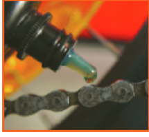
▲ الزيت، سائل، يساعد سلسلة الدراجة الهوائية على الحركة بسلاسة.
