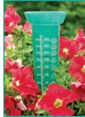
**مقياس المطر** أداة تُستخدم لقياس مقدار المطر المتساقط
